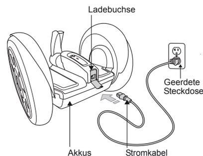
Während des Ladens leuchten die Ladeanzeigeleuchten grün. Wenn die Akkus voll sind, blinken die Ladeanzeigeleuchten grün. Rot bedeutet einen Fehlerzustand!
