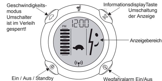
Wenn der Funkkontakt zwischen Key und Segway unterbrochen ist, kurz die Ein / Aus Taste drücken!
